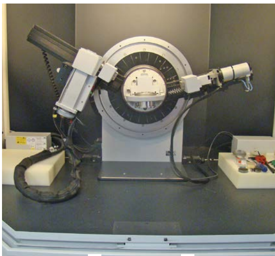
Bild 4: Röntgendiffraktometer zur Bestimmung des Restaustenitgehalts
