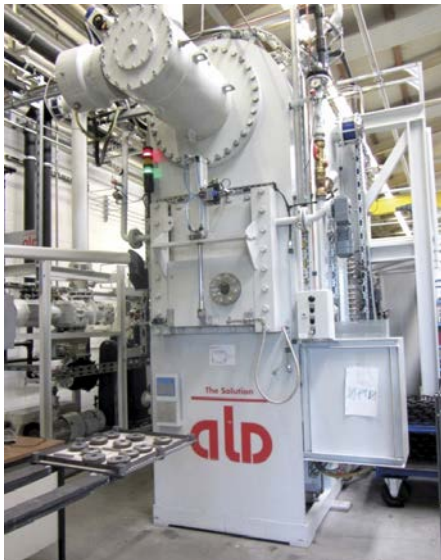
Bild 3: Synchrotherm- Vakuumofen und zu behandelnder Probensatz
