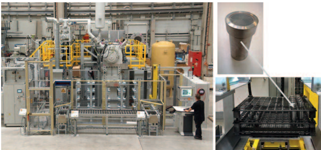
Bild 9: SyncroTherm® System zum Löten von Luftfahrtteilen auf CFC- Werkstückträgern
